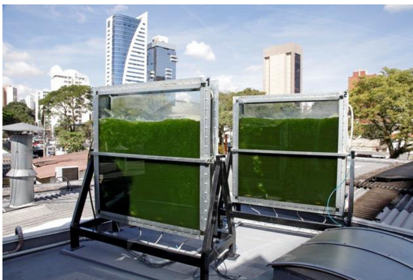
Figura 7 – Fotobiorreator em forma de placa.
