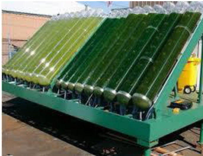
Figura 6 – Fotobiorreator em forma de tubo.
